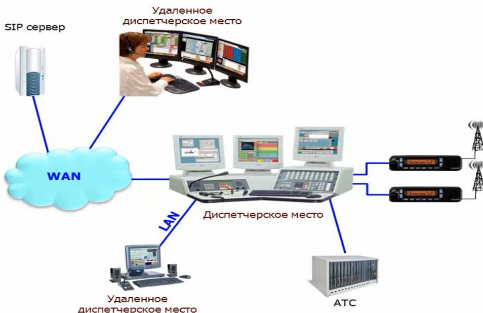
Рисунок 4 – Организация комплексного диспетчерского управления радиосети
