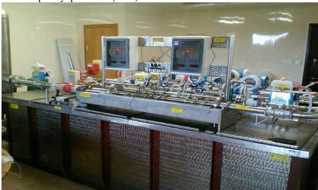
Рисунок 1 - Общий вид установок поверочных УПР-50М
