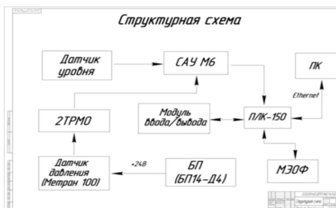
Рисунок 1 – Структурная схема САУ
