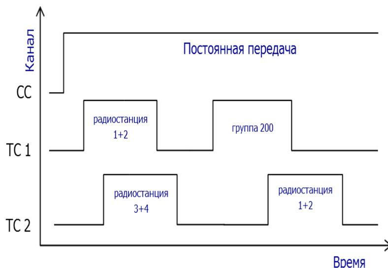
Рисунок 3 - Типичная последовательность распределения канала
