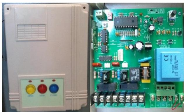
Рисунок 2 – Блок управления AN MOTORS ASB6000
