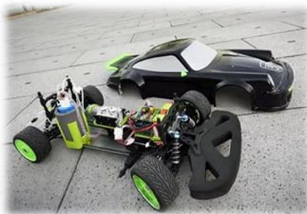
Рисунок 1 – Прототип автомобиля, работающего на муравьиной кислоте
