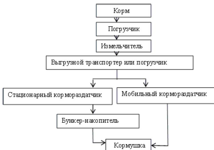
Рисунок 1 – Технологическая линия приготовления и раздачи кормов
