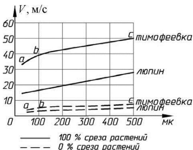
Рисунок 4 - Зависимость скорости среза культуры от толщины режущей кромки ножа
